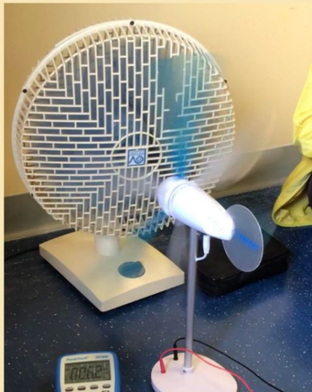
Il ventilatore che fa girare le pale della pala eolica
